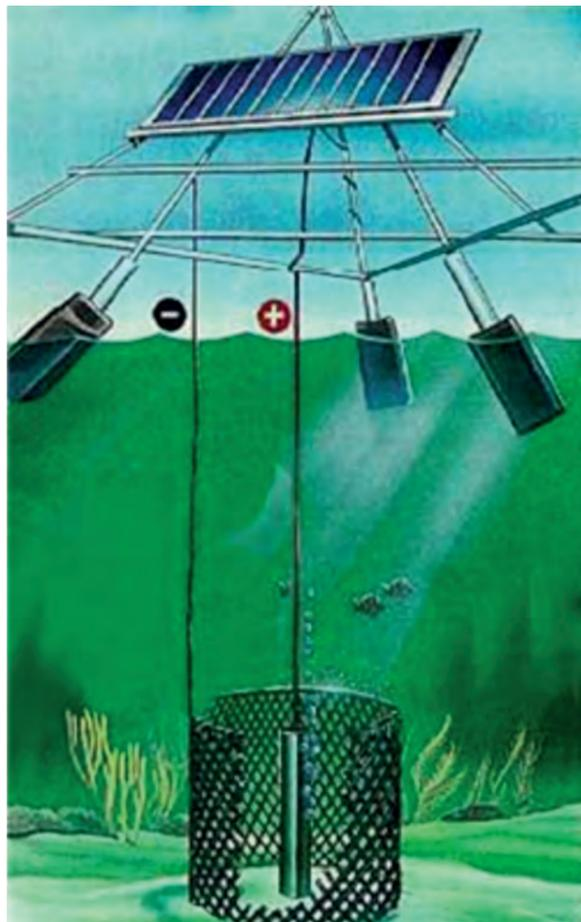
Schéma de principe d'électrodéposition (© Biorock.net)
